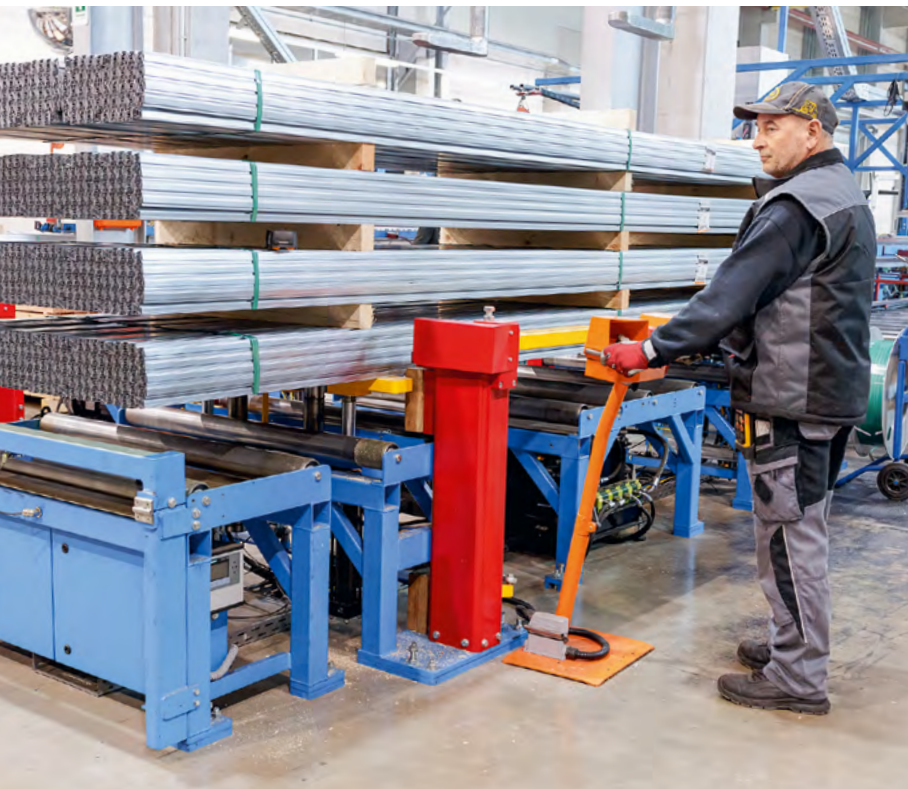
Abbildung 5: Die Stapelhilfe fährt auf Knopfdruck Schwenkarme aus und hebt die Profilbunde hydraulisch an. Dann wird eine weitere Lage Bunde darunter befördert.
