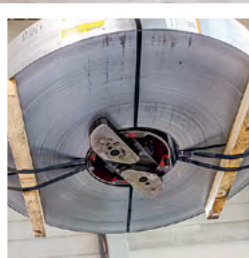
Abbildung 3 und 4: Die Coilbombe hebt tonnen schwere Spaltbänder an. Mitarbeitende bleiben beim Anschlagen der Last außerhalb des Gefahrenbereichs.
